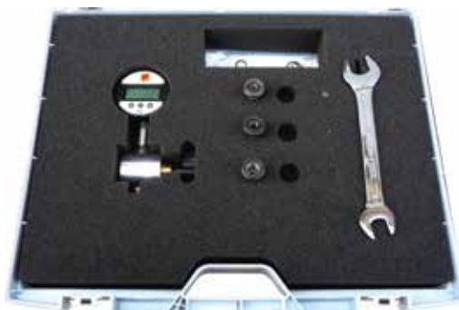
Gasfeder-Ablasskoffer zum kontrollierten Ablassen von Stickstoff bei Gasfedern. Der Koffer enthält alle notwendigen Ablass-Schrauben und einen Manometer zum Prüfen des verbleibenden Drucks in der Gasfeder.
