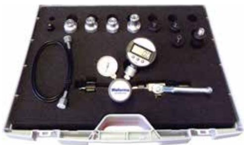
Gasfeder-Füllkoffer zum füllen und anpassen von Gasfedern vor Ort. Der Koffer enthält alle Füllglocken und Ablaßschrauben. Der Füllkoffer ist passend für 200 bar Stickstoff-Flaschen mit Gewinde W24,32x1/14". Stickstoff ist im Lieferumfang nicht enthalten.
